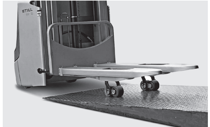
Идеально подходит для использования на рампе: благодаря опциональной функции базового подъема модель EXV легко въезжает на рампу
