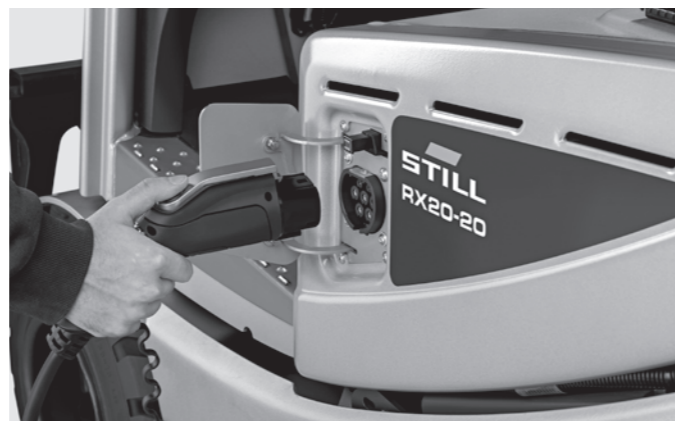
Опциональное встроенное зарядное устройство для децентрализованной зарядки АКБ, без необходимости её замены
