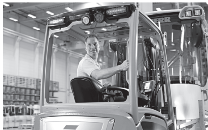
Откидное сиденье для обзора сзади и поручень с возможностью установки звукового сигнала в виде опции
