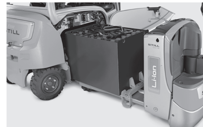
Замена аккумуляторных батарей производится с помощью электротележек
