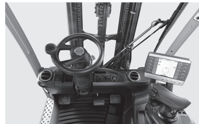
Рабочее место оператора, оснащенное пультом управления с дисплеем, джойстиком Joystick 4Plus и системой обогрева
